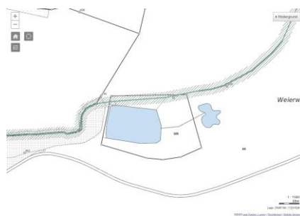
Abbildung 3: Künstlich angelegtes Gewässer im Gebiet «Weierweid» (Parzellen Nr. 105) mit theoretischem Gewässerraum | Quelle: www.geoportal.lu.ch (Download am 12.04.2023)
