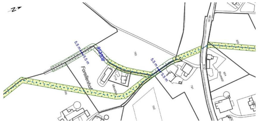
Abbildung 34: Umsetzung der Gewässerraumfestlegung entlang des Moosgrabens (Gewässer-ID 463507), Abschnitt Nord und entlang des Gewässers mit der Gewässer-ID 953508 (Zufluss)
