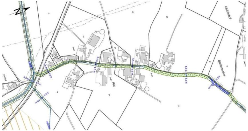
Abbildung 44: Umsetzung der Gewässerraumfestlegung entlang des Rotherbächlis (Gewässer-ID 463034), Ausschnitt Süd
