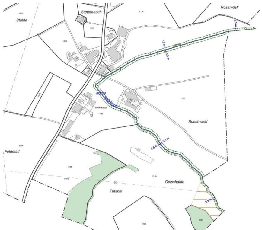
Abbildung 43: Umsetzung der Gewässerraumfestlegung entlang des Rohrbachs (Gewässer-ID 463030)
