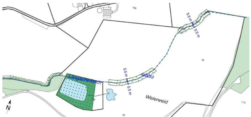
Abbildung 38: Umsetzung der Gewässerraumfestlegung entlang des Längacherbachs (Gewässer-ID 463053), Ausschnitt Ost
