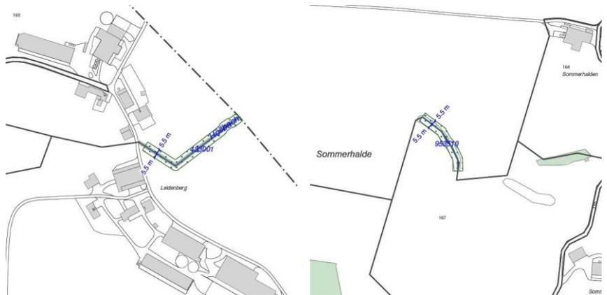
Abbildung 45: Umsetzung der Gewässerraumfestlegung entlang des Höllbachs (Gewässer-ID 433001, links) und entlang des Sommerhaldegrabens (Gewässer-ID 953510, rechts)
