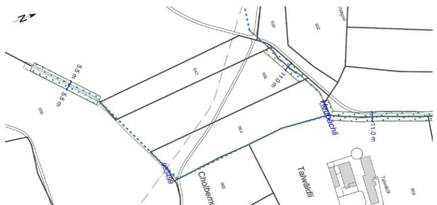
Abbildung 26: Umsetzung der Gewässerraumfestlegung entlang der Gewässer-ID 953499 (Zufluss des Heubächlis)
